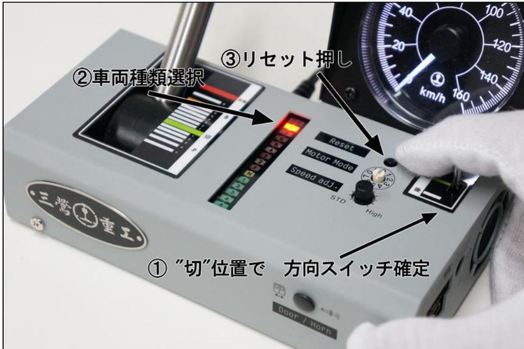
☞ マスコンの段位位置を B8 の位置に合わせリセット押し後," Ding" ATS 音と電車スタート音が出ましたら、起動モード2 になり E231 系 500 番の VVVF 音に設定が完了です。
