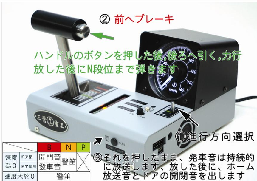
☞ 暴走を避ける為、方向スイッチを中間位置に合わせて下さい、この際ソフト更新用ケーブルとUSBケーブルを接続しないようにして下さい。確認後にACアダプターをコンセントに接続して下さい。
