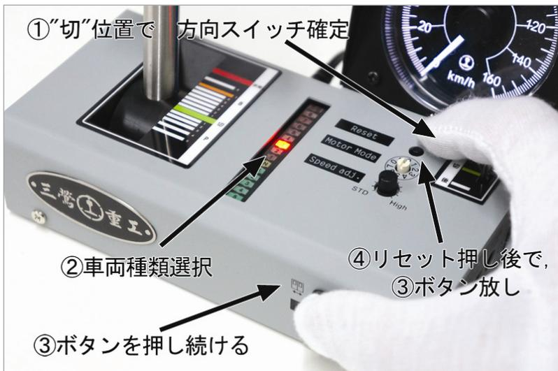
☞ マスコンの段位位置を B3 の位置に合わせリセットを押した後、ドア開-閉ボタンを押し、再びリセットを押すと,"Ding"ATS音が出ますので、ドア開-閉ボタン放します(合計は2つの"Ding"が聞こえます),これで設定が完了です。
