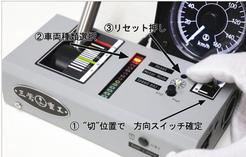
☞ マスコンの段位位置を B8 の位置に合わせリセット押し後,"Ding"ATS音と電車スタート音が出ましたら、起動モード2になりE231系500番のVVVF音に設定が完了です。
